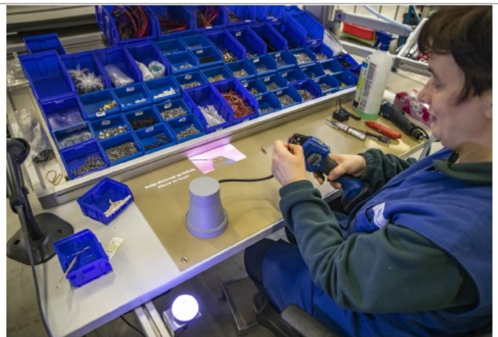
Lichtwerk: De instructies worden geprojecteerd op de werkplek. © Sebastian Steveniers
